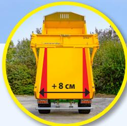
Плавная выгрузка благодаря кузову конической формы из стали HARDOX 450
