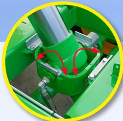
Телескопический цилиндр опрокидывания с двойным качанием установлен в выдвинутом положении на шасси
